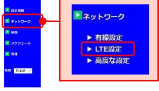
2) SIM の情報を確認し、入力し、[LTE テスト] をクリックします。「SIM の状態」は SIM カードの挿入状態を表しています。
