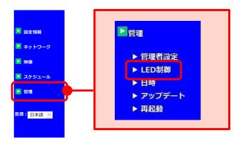
[LED 表示 OFF] または [ネットワーク 接続後 LED 表示 OFF] のいずれかを選択 します。
