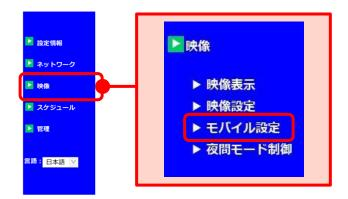
2) 画面右側に〈モバイル設定〉が表示されます。画面下部の音声の欄で[音声無効]を 選択します。
