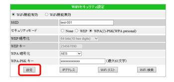
7)右図の画面が表示されれば設定完了です。カメラを Wi-Fi 接続にする際は、<u>カメラから LAN ケーブルを抜いてください。</u>
