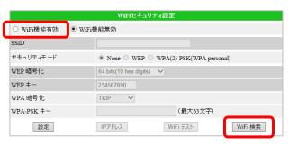
カメラ周辺の使用可能な Wi-Fi の SSID が 表示されます。カメラを接続したい Wi-Fi の SSID をクリックします。
